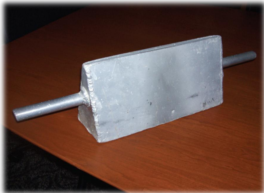
Figura 7. Caja - tipo de dispositivo de muestreo a granel
