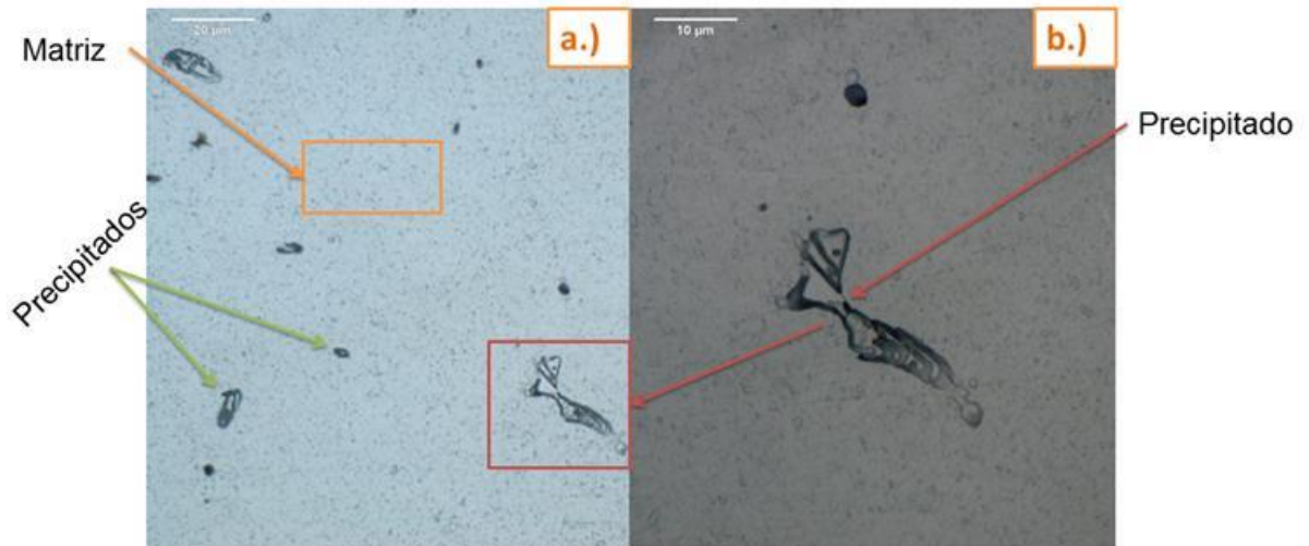
Figura 11. Micrografía óptica de aluminio con adición de polvos de óxidos de manganeso, puesta en contacto mediante fundición n° 3. a) 500x y b) 1000x. Keller-0.5%HF.
