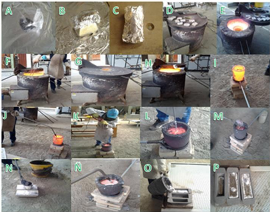
Figura 4. Secuencia de imágenes que muestran el proceso de incorporación del polvo catódico en aluminio líquido, mediante agitación.
