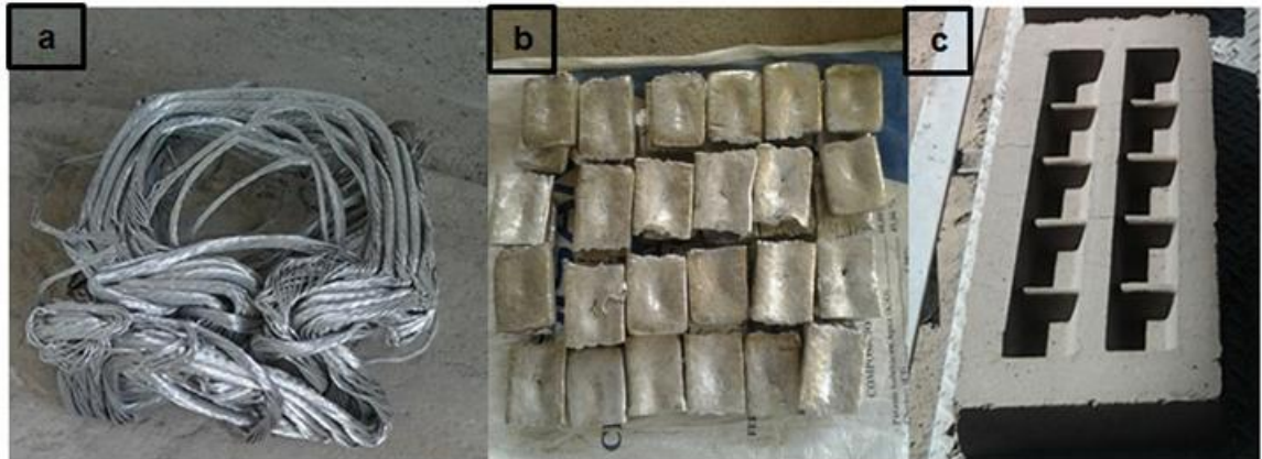
Figura 2. Producto de la transformación de alambrones de aluminio base en lingotes, a.) Alambrones de chatarra de aluminio, b) Lingotes producidos de la fundición de chatarra de aluminio base y c.) Molde en arena con capacidad para 10 lingotes.
