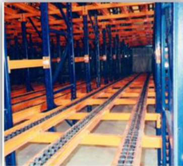
Figura 7: Estanterías dinámicas o de flujo.
