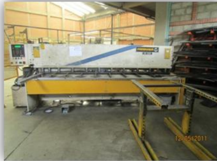
Figura 11: Cizalla con guillotina hidráulica y control numérico MEBUSA.
