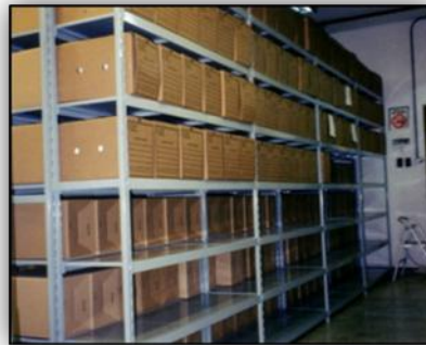
Figura 9: Estantería Mini Rack 40 para cargas livianas.
