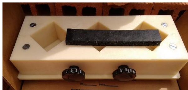
Figura 8. Molde para cubos de 50 mm.
