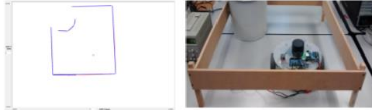
Figura 15. Mapa generado por medio de escaneo láser.
