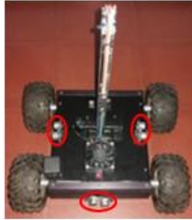
Figura 65. Disposición de los sensores ultrasónicos sobre el robot.
