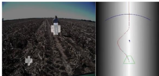
Figura 22. Sistema de detección de obstáculos y áreas de cubrimiento de los sensores.
