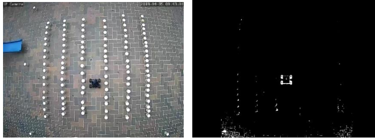
Figura 112. a) Mapa original, b) Umbral del robot igual al del mapa.
