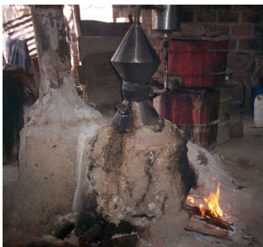
Figura 12. Alambique convencional utilizado para la producción de ron.
