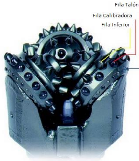
Figura 19. Broca Tricónica, estructura de corte convencional
