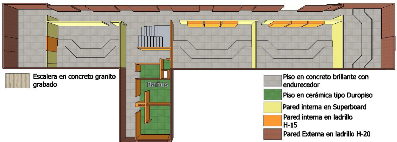
Figura I.16. Detalle Piso 4: Pisos, muros y divisiones.
