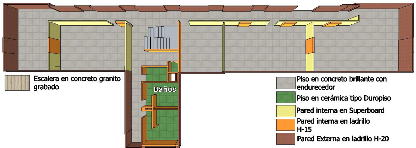
Figura I.14. Detalle Piso 3: Pisos, muros y divisiones.
