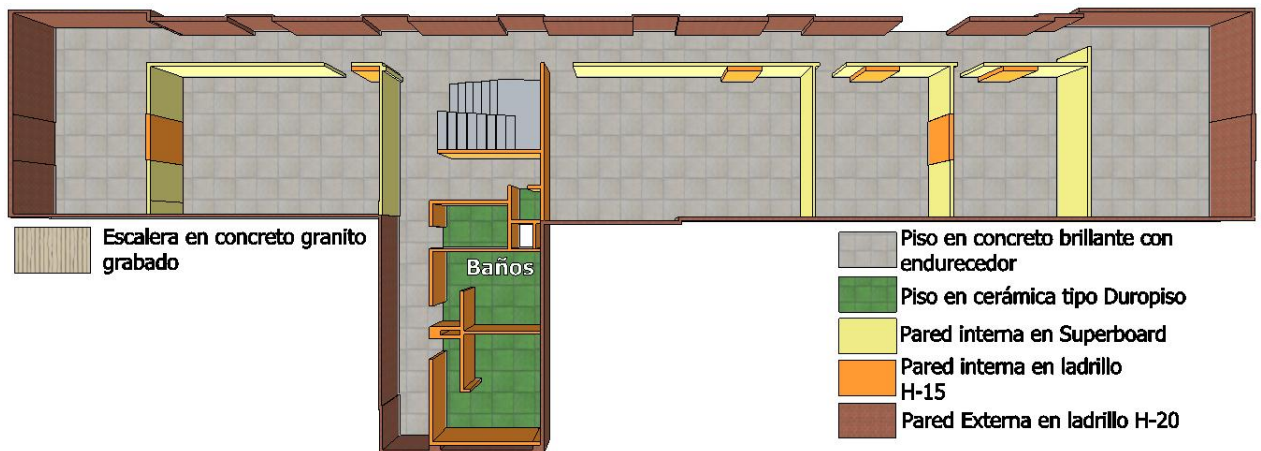
Figura I.12. Detalle Piso 2: Pisos, muros y divisiones.
