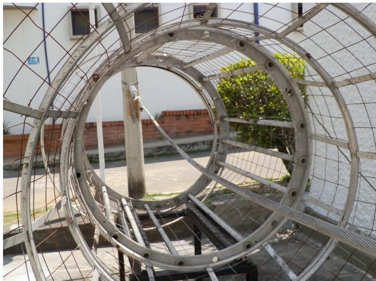
En la figura 1.3 se presentan las dimensiones físicas de la malla. En cuanto al conductor central, se trata de un cable AAAC tipo *Flint* el cual tiene un radio de  $r_0 = 1,26$  cm.
