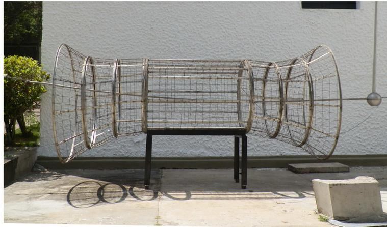
Como se puede observar, la parte externa de la configuración coaxial no es sólida. Esta consiste en un enmallado de alambres de acero que son soportados por una estructura constituida de dos aros y varios tubos que los unen (ver figura 1.2). En este sentido, la calidad de la “circunferencia” externa está determinada por la cantidad de tubos que se utilicen.
