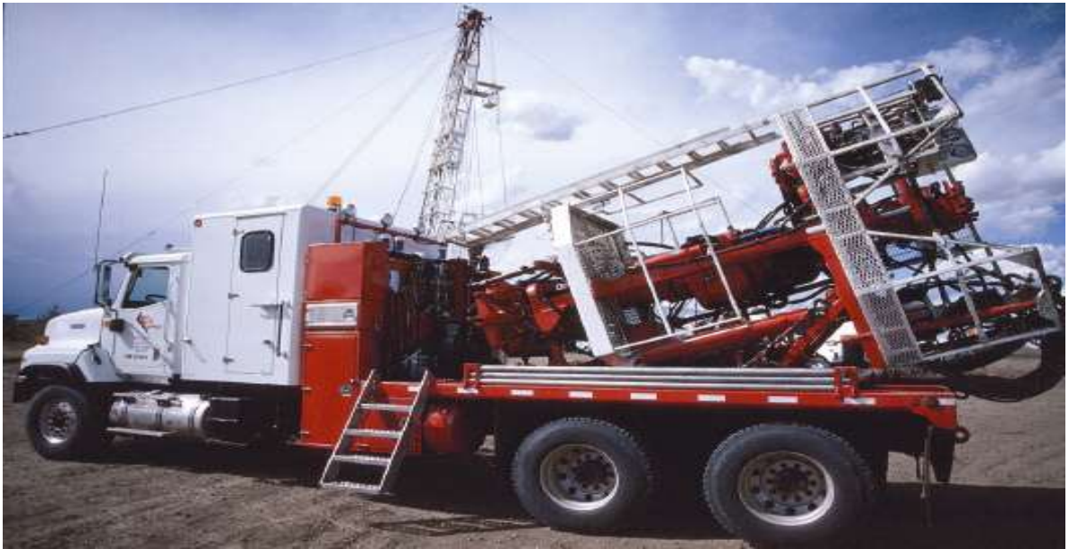
Figura 2.3. Unidad HRA montada sobre un camión especializado para el transporte y el suministro de potencia hidráulica.
