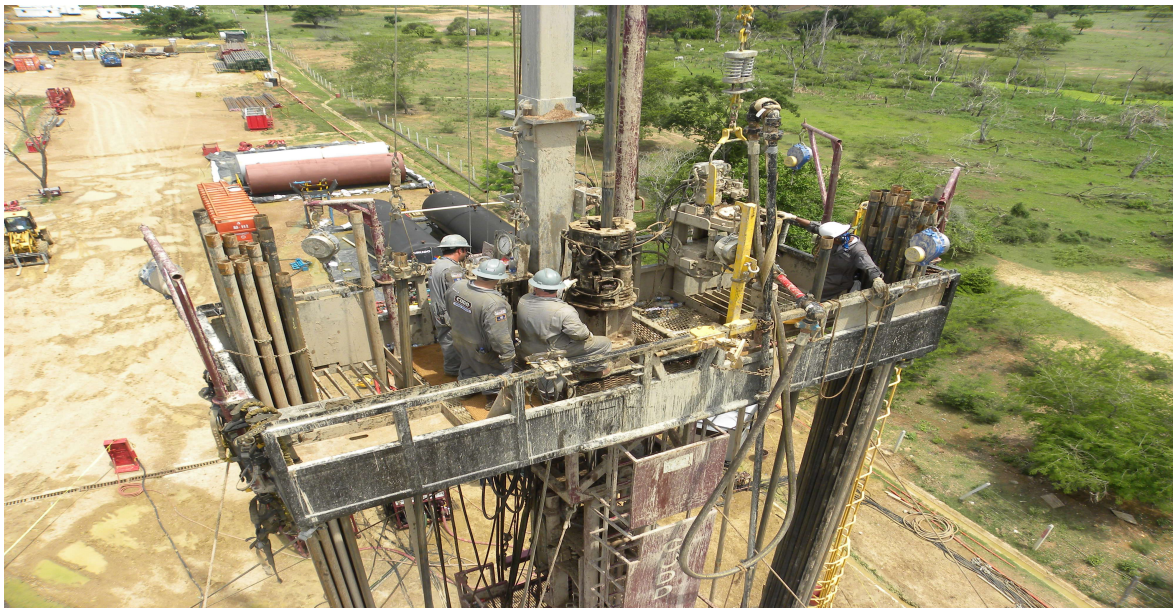
Figura 2.8. Cesta de trabajo de una unidad Snubbing/HWO
