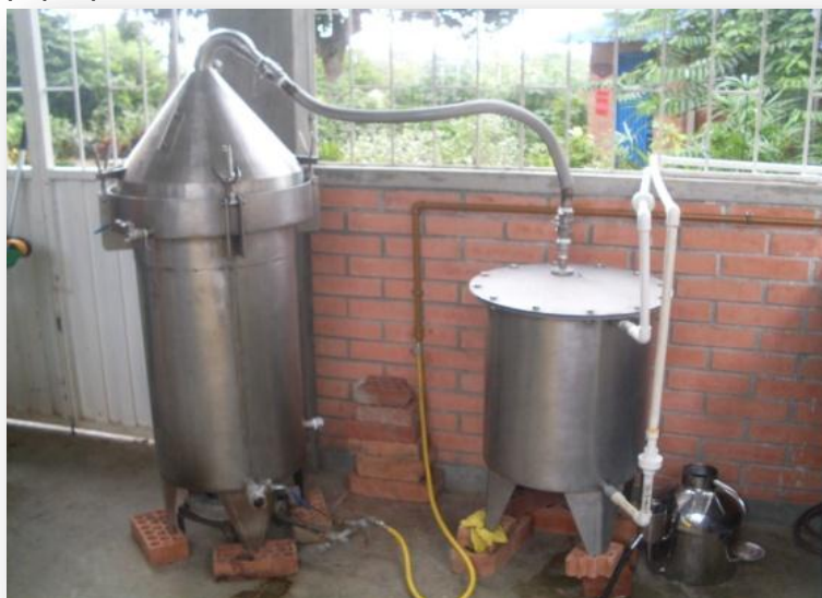
Figura 5. Equipo piloto de hidrodestilación.
