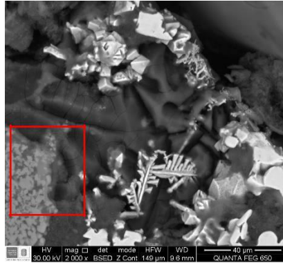
Figura 22. Micrografía de la zona de interés de la aleación 1 obtenida con SEM a 2000 x.
