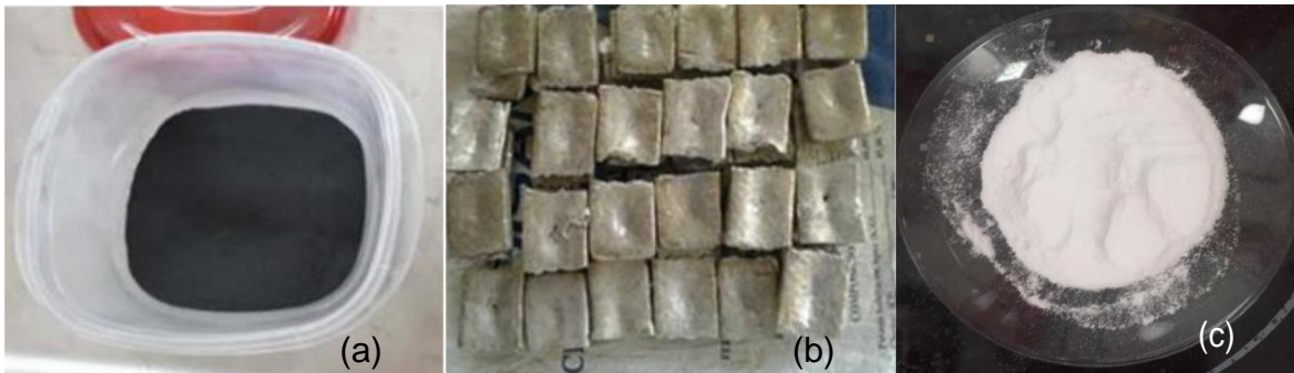
Figura 4. Materias primas empleadas en el proceso de fusión. (a) Aspecto visual del polvo catódico pasante malla 140, (b) Lingotes obtenidos de la fundición de alambres de aluminio y (c) Aspecto visual del fundente Tetraborato de litio.
