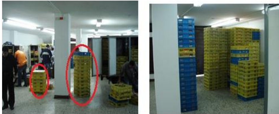
Figura 19. Evidencia gráfica de la ausencia de zonas demarcadas
