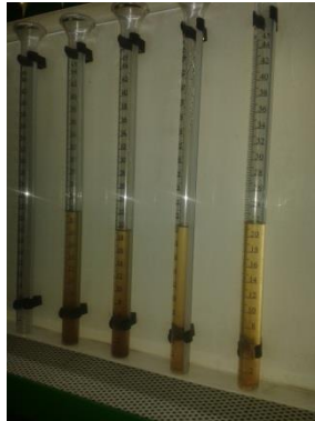
Figura 45. Diferencia de caudal bomba rotativa VE.
