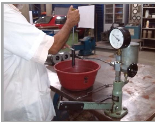
Figura 31. Probador manual de inyectores mecánicos.
