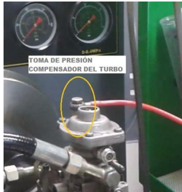
Figura 44. Compensador del turbo bomba rotativa VE.
