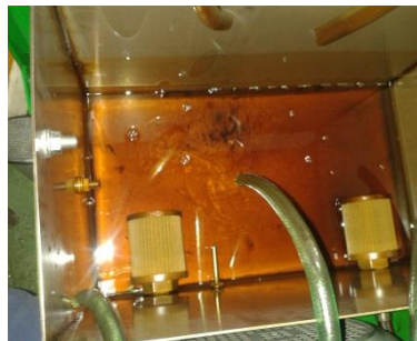
Figura 54. Aceite de prueba contaminado banco HUS 1001
