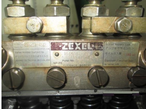
Figura 27. Placa de la bomba en línea PE-A.
