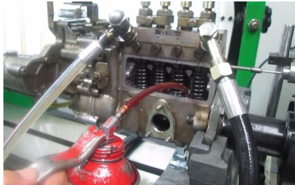
Figura 32. Lubricación del eje de levas bomba en línea PE-A.
