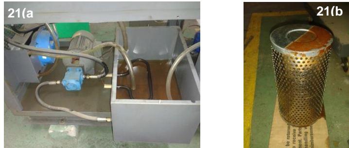
Figura 21. A) Depósito de combustible. B) Filtro de malla. Banco TST-C
