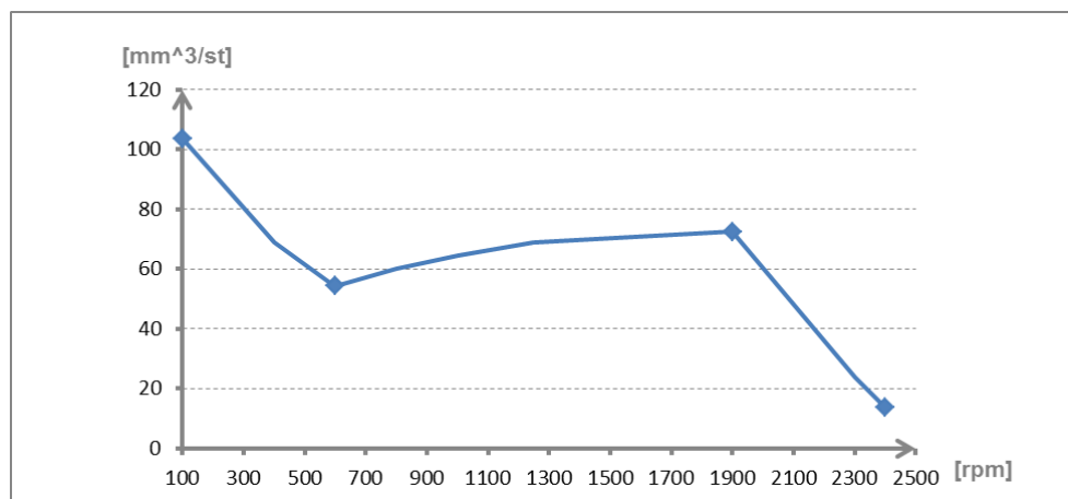
Figura 46. Curva INYECCION Vs RPM bomba rotativa VE.
