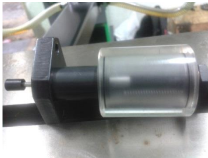
Figura 43. Purga del medidor de carrera.
