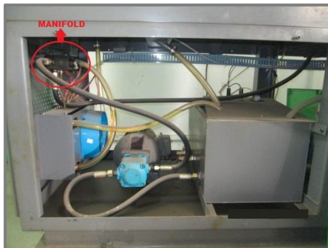
Figura 16. Manifold del banco TST-C.
