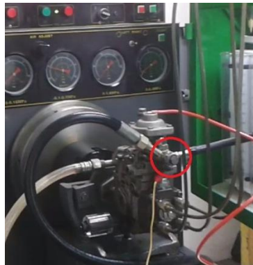
Figura 40. Válvula de retorno bomba rotativa VE.
