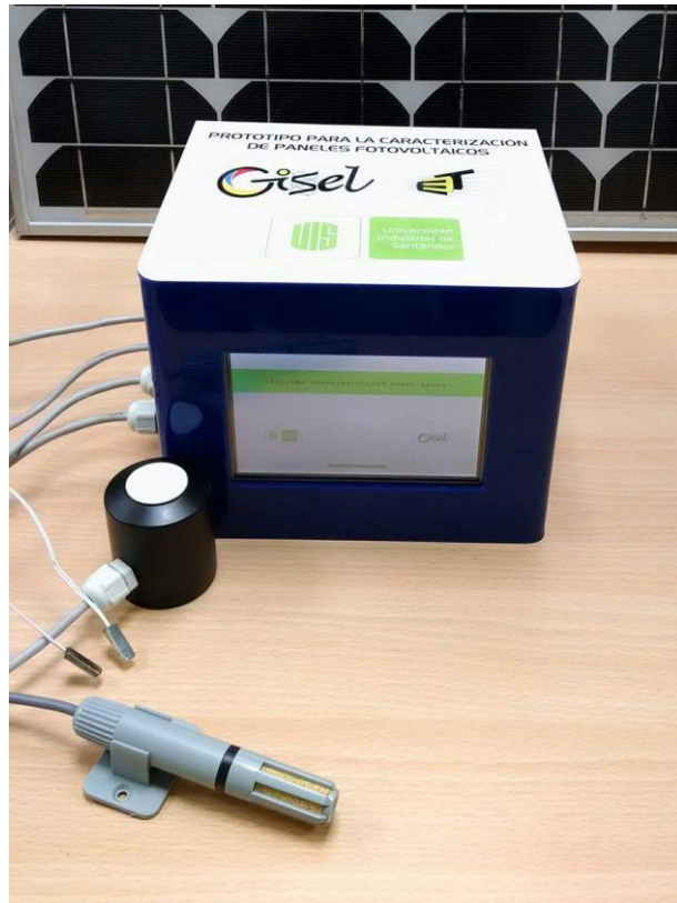
Imagen 31. Prototipo para la caracterización de paneles fotovoltaicos
