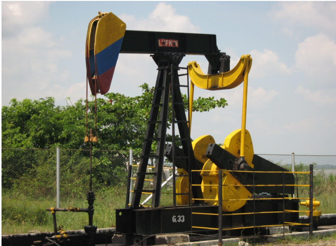
Figura 4. Unidad de bombeo Convencional
