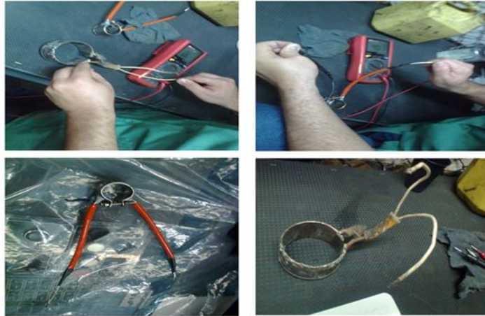
Figura 61: Análisis de continuidad y ohmiamje de las resistencias
