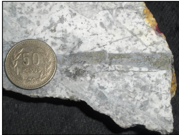
Figura 45. Muestra alterada con presencia de venas de cuarzo más pirita.
