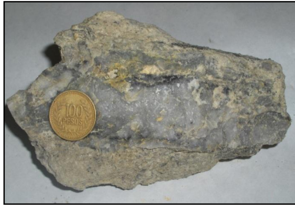
Figura 23. Muestra de mano de vena de solo cuarzo dentro de cuerpo granítico altamente sericitizado.
