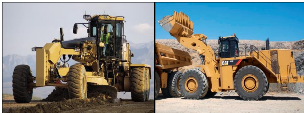
Figura 13. Motoniveladora y Cargador
