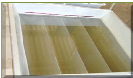
Figura 7. a) Marca de nivel b) control de flujo de agua en un evaporador acanalado
