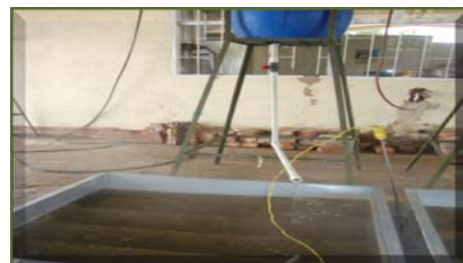
Figura 7. a) Marca de nivel b) control de flujo de agua en un evaporador acanalado
