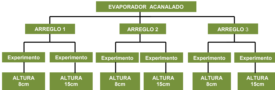
Figura 6. Diseño factorial para los evaporadores acanalados.
