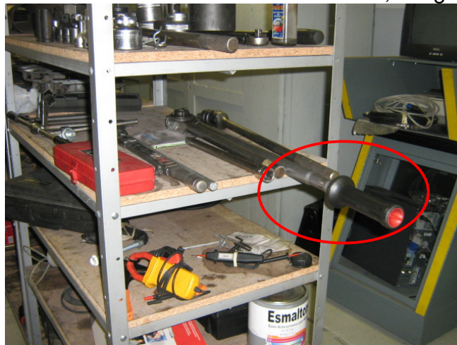
Figura 36. Almacenamiento incorrecto de la herramienta, riesgo de daños.
