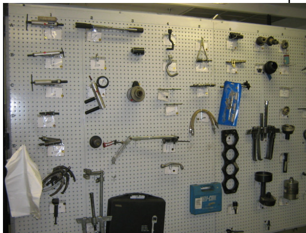
Figura 37. Tableros de herramientas con indicaciones de la posición de éstas.
