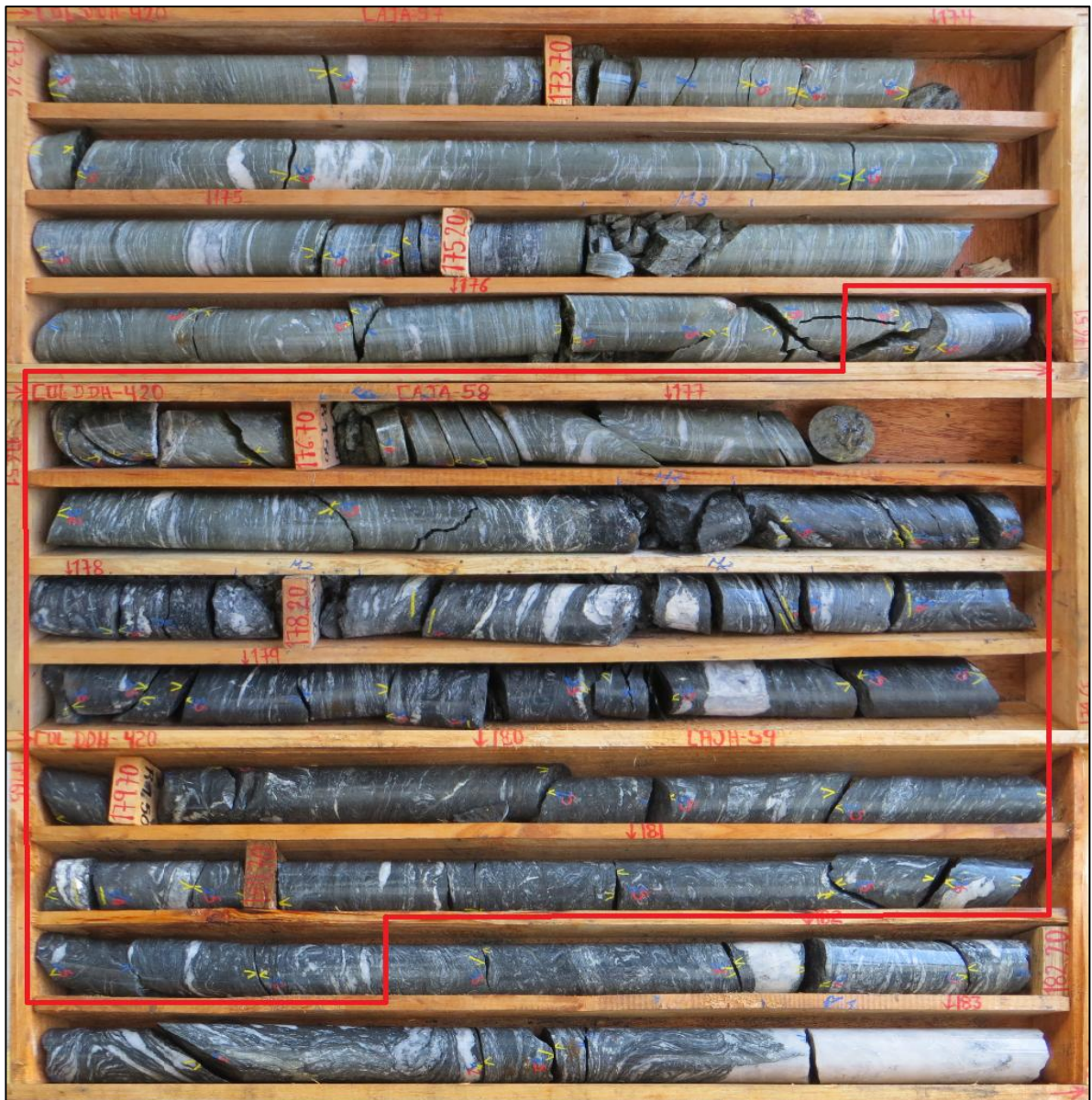
Figura 56. Tramo N° 7, Pozo COL-420, Falla La Cristalina
