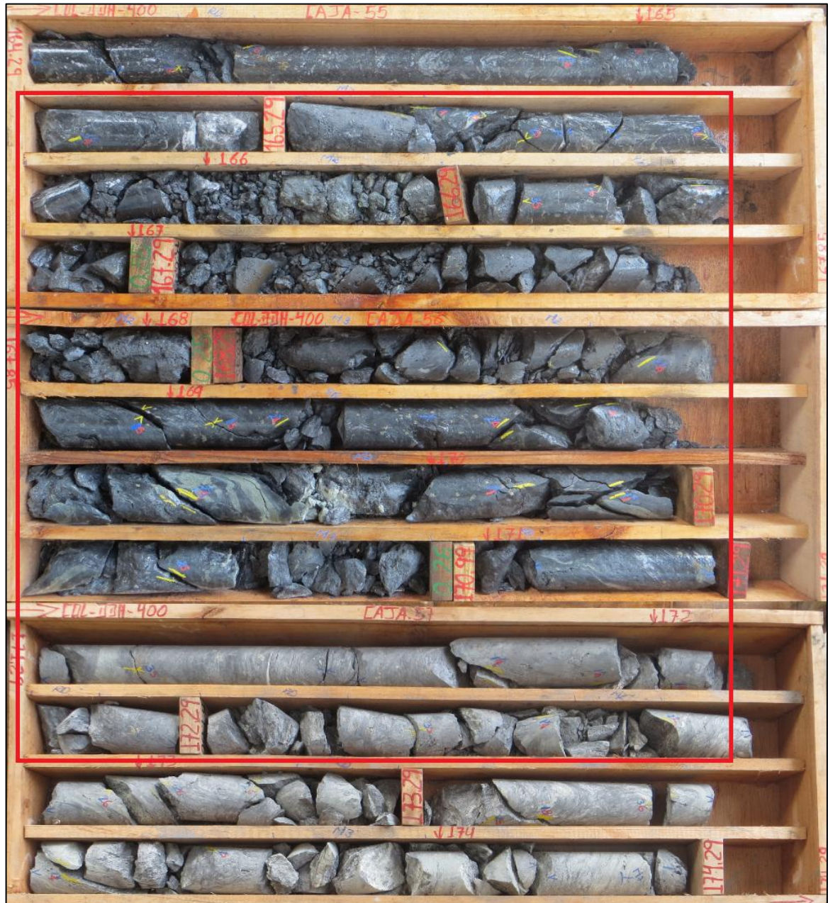
Figura 42. Tramo N° 2, Pozo COL-400, Falla La Ceja
