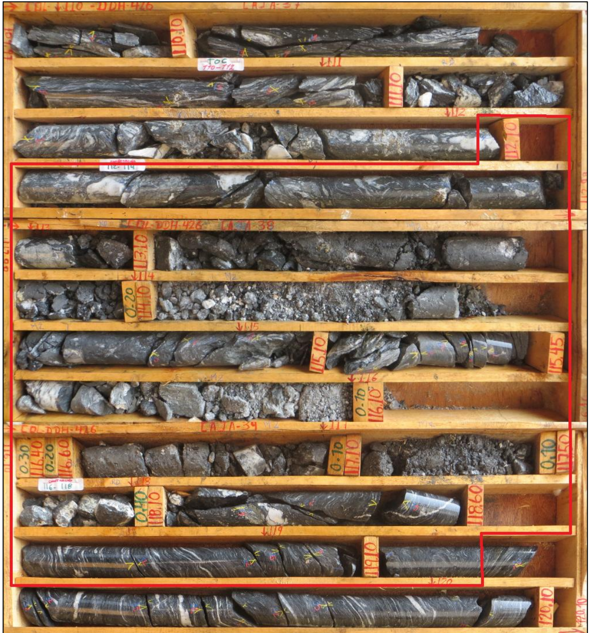
Figura 62. Tramo N° 10, Pozo COL-426, Falla La Cristalina
