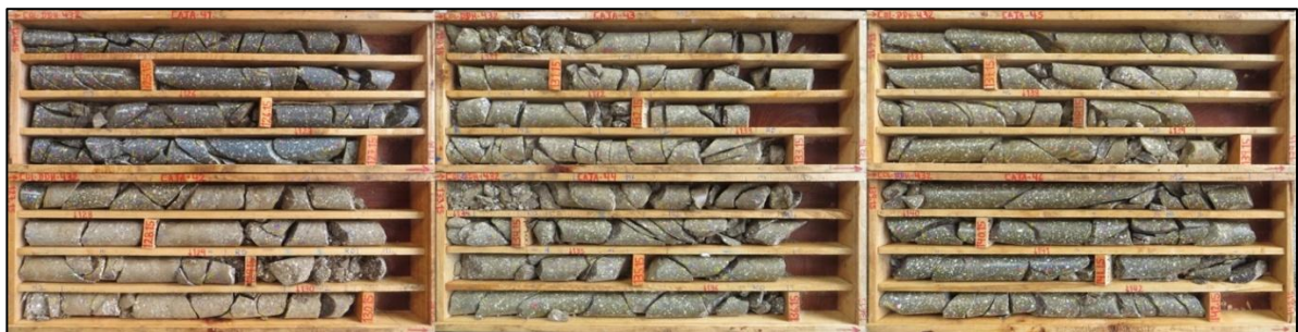
Figura 31. Identificación de sector de interés para evaluación de conductividad hidráulica con ensayo Lugeon. Tramo de 128 – 138 m, Pozo COL-432
