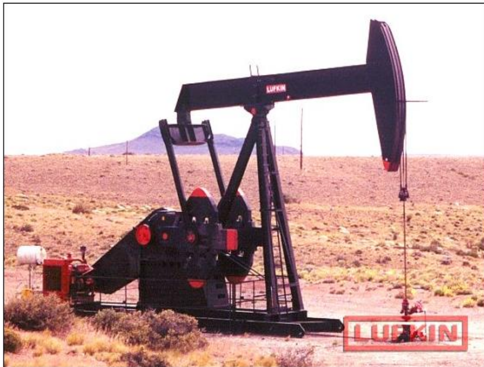
Figura 23. Unidad de bombeo convencional
