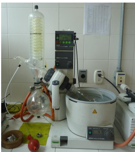
Figura G2. Rotoevaporador BUCHI R-200 utilizado para extraer el hexano
