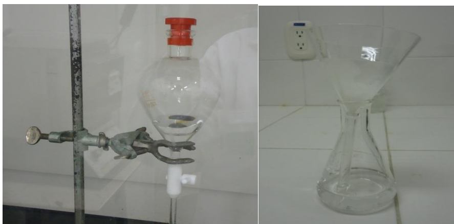
Figura G1. Montaje extracción líquido-líquido.
