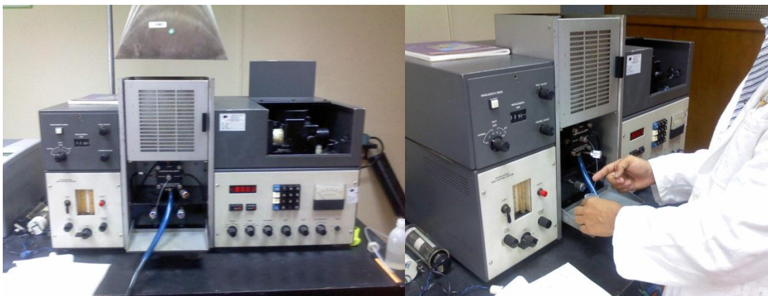
Figura D1. Equipo de Absorción Atómica Perkin-Elmer utilizado para la determinación de metales pesados
