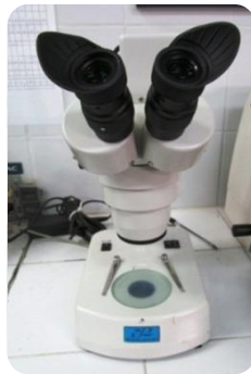
Figura 30. Microscopio estereoscópico de cámara incorporada. COLE PARMER. [Fuente: Autora]
