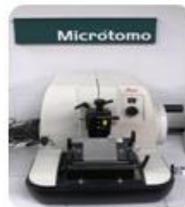
Figura 34. Micrótopo de rotación. LEICA. [Fuente: Autora]
