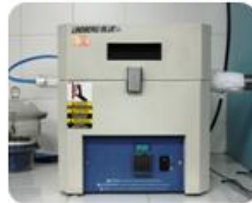
Figura 33. Horno tubular eléctrico de laboratorio. LINDBERG/BUE. [Fuente: Autora]
