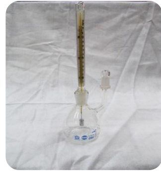
Figura 36. Picnómetro Blaubrand con termómetro y capilar lateral.
