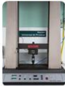
Figura 30. Equipo Universal de Ensayos. Tinius Olsen. [Fuente: Autora]
