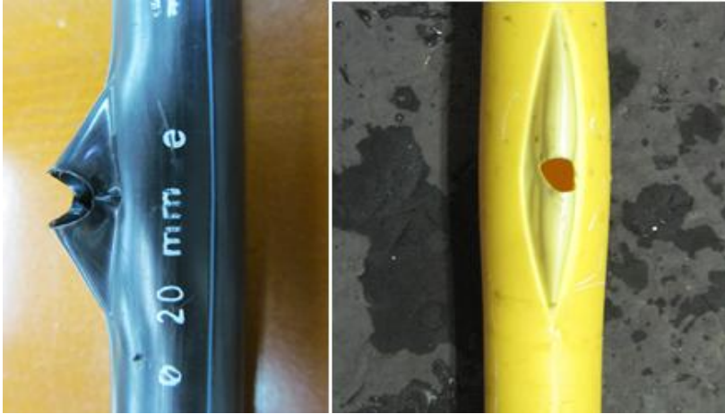
Figura 5. Falla dúctil tipo pico de loro en tubería de PE.
