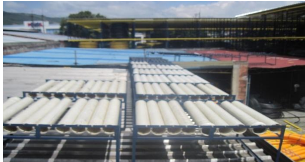
Figura 3. Montaje tubería 110mm RDE 17 PE100 AGUA, 20mm RDE 7,5 PE40, 4PULG PR-200 BIAxIAL y PVC 4PULG UNION Z RDE 21
