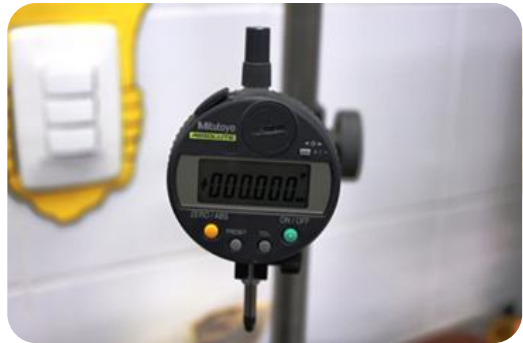
Figura 34. Reloj comparador. Absolute Difimatic ID-C. [Fuente: Autora]
