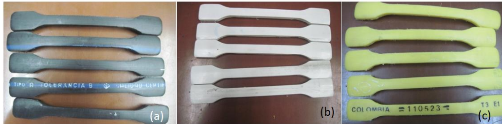
Figura 18. Probetas tipo hueso de perro para el ensayo a la resistencia a la elongación. PE agua (a), PVC (b) Y PE gas (c).
