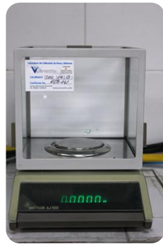
Figura 29. Balanza analítica Mettler AJ100. [Fuente: Autora]
