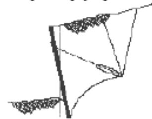
e. Falla en el muro por una insuficiente resistencia (por empuje) pasiva
