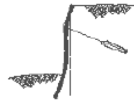
e. Falla en el muro por una insuficiente resistencia (por empuje) pasiva
