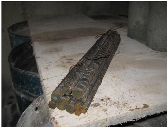
Figura 12. Muestras de acero para ensayo
