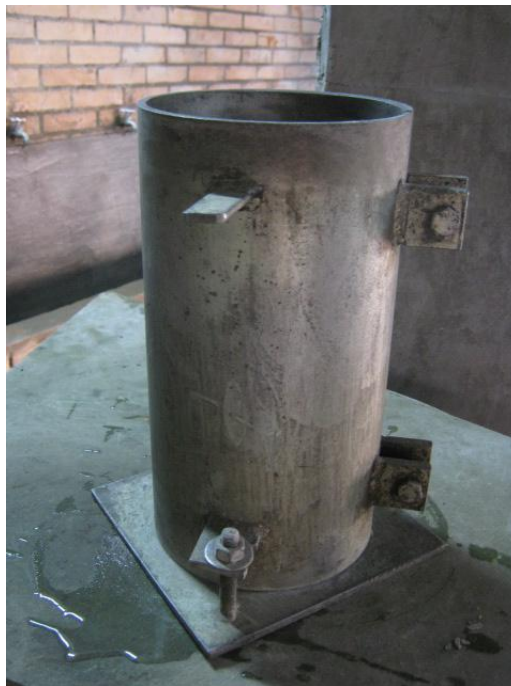
Figura 2. Molde cilíndrico de acero
