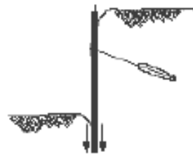
g. Falla por insuficiente capacidad axial
