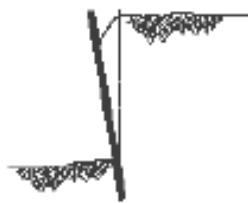
f. Falla por rotación hacia adelante
