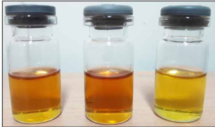
Figura 8. Comparación de los cambios físicos presentados por el aceite aviar, esterificado y transesterificado (biodiesel).
