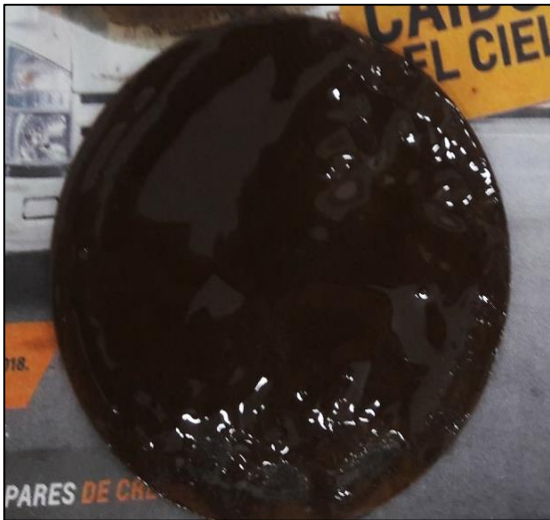
Figura A.6 Cake del diesel y biodiesel respectivamente.
