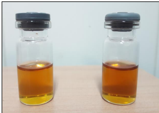
Figura 7. Comparación de los cambios físicos presentados por el aceite aviar y aceite esterificado.
