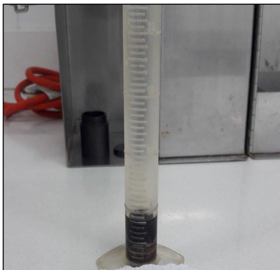
Figura A.8 Filtrado API diesel y biodiesel respectivamente.
