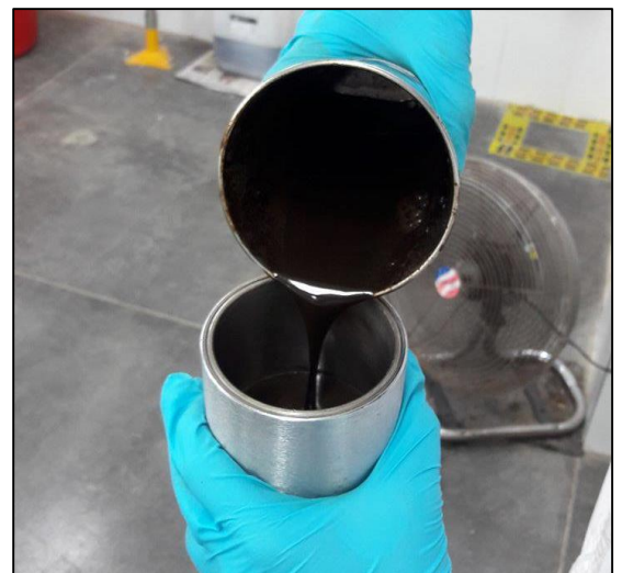
Figura A.1 Formulación 90/10 Diesel y Biodiesel respectivamente
