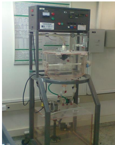
Figura 23. Equipo erosión corrosión por chorro de impacto.
