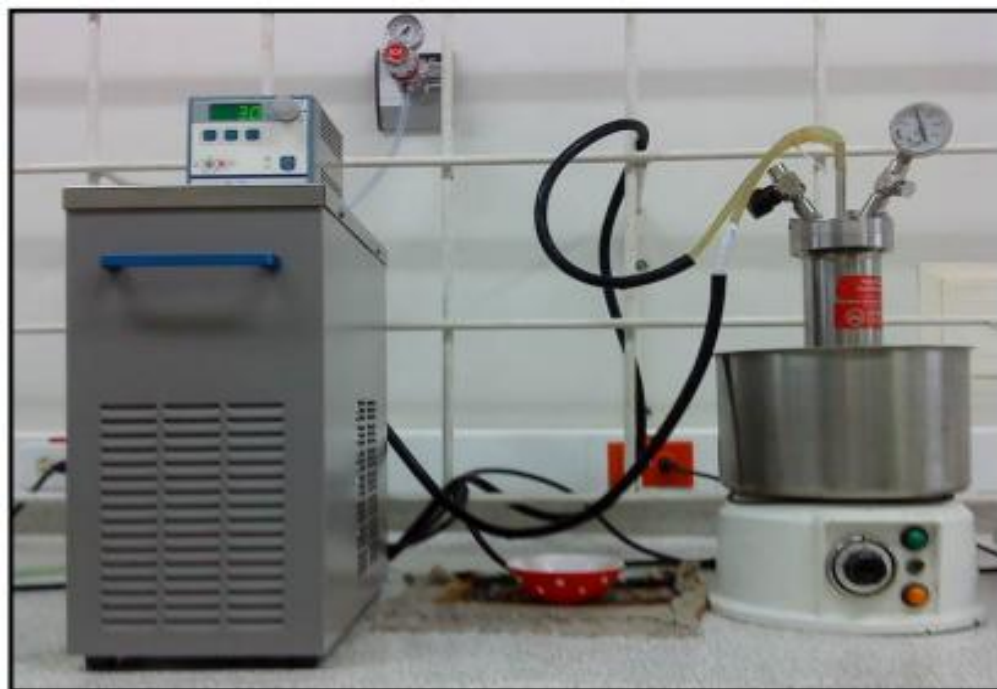
Figura 16. Extractor Soxhlet de alta presión, introducido en el baño maría [57].
