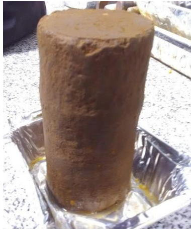
Figura 12. Probeta con humedad óptima de compactación después del ensayo triaxial.
