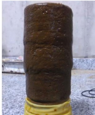
Figura 14. Probeta con ciclo de secado y humedecimiento después del ensayo triaxial.
