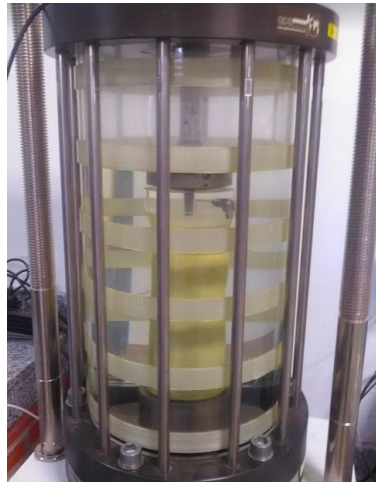
Figura 8. Preparación de la muestra de suelo con las dimensiones requeridas por la cámara de la máquina Triaxial.
