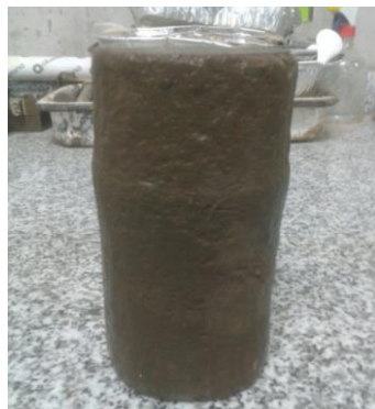
Figura 13. Probeta con pérdida de humedad (más seca) después del ensayo triaxial.
