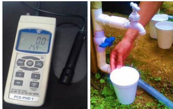
Figura 12. (a) Conductivímetro PCE-PHD1, (b) Toma de una muestra del efluente.
