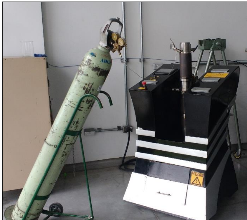
Figura 14. Inyección de gas CO_2 en el equipo Bulk 350
