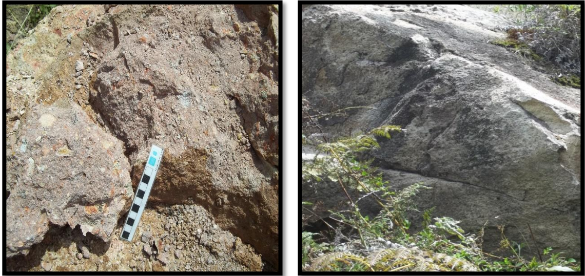
Figura 23. Ignimbrita con alto grado de alteración (Izquierda), presenta colores rojizos. Roca fresca (derecha) colores blancos o claros. (Fuente: Autores)
