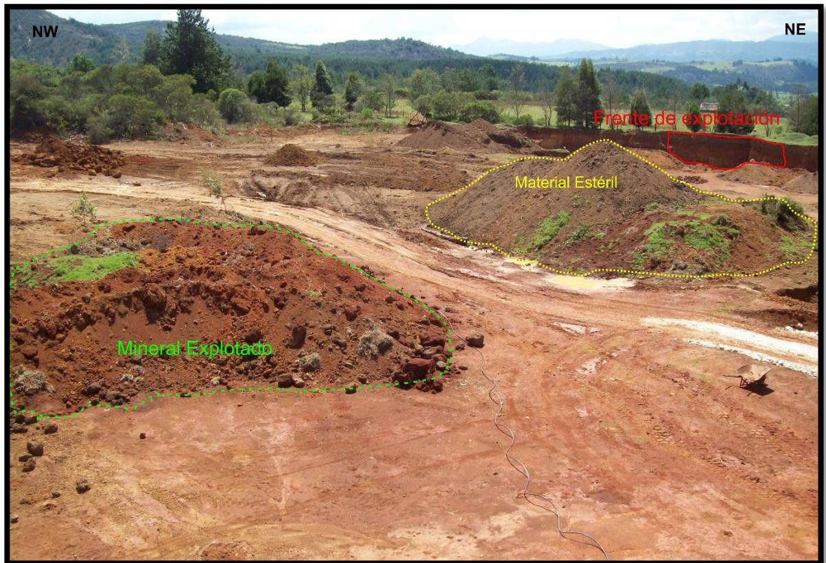
Figura 9. Mina de Hierro Sector La Capilla. Actualmente en explotación. Se observan los montículos de material estéril, el mineral explotado y el frente de explotación. (Fuente: Autores)
