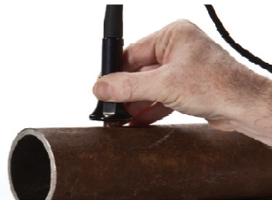
Figura 55. Medición del espesor de una tubería. Fuente: Medidor de espesor por ultrasonidos 38DL plus, Olympus.
