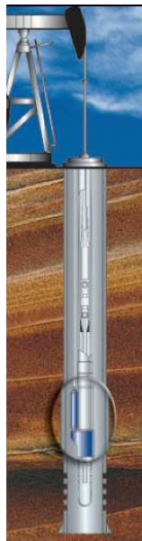
Figura 9. Lugar de instalación de medidores de fondo de pozo. Fuente: Sistemas Phoenix de monitoreo de fondo de los equipos de levantamiento artificial.
