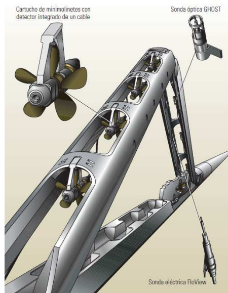
Figura 152. Herramienta FlowScanner de Schlumberger para la medición de flujo multifásico. Fuente: Perfilaje y cuantificación de pozos de flujos multifásicos complejos , Schlumberger.
