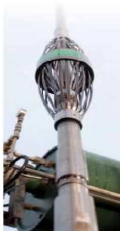
Figura 63. Escáner electromagnético para medición de espesor de las tuberías. Fuente: EM Pipe Scanner, Schlumberger.
