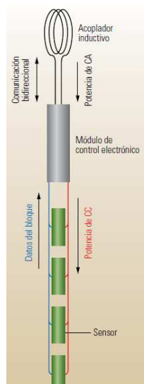
Figura 195. Medidor inalámbrico con acoplador inductivo.
