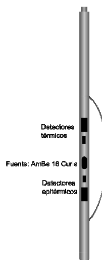
Figura 178. Herramienta de registro CNL. Fuente: Autores
