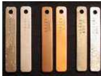
Figura 51. Cupones de corrosión. Fuente: http://www.pcenvironmental.org/cooling%20tower%20water%20treatment.htm
