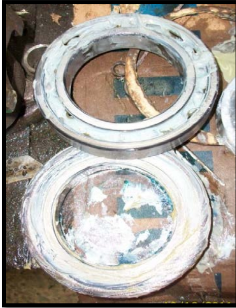
Figura 41 RODAMIENTO 6014 ya desmontados de la Manzana 194
