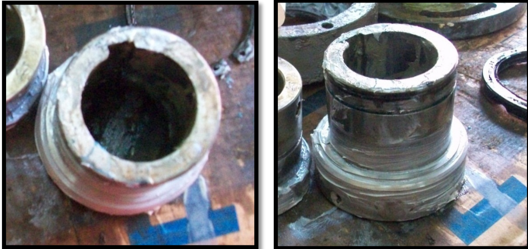
Figura 21 FLANCHE (Como cuerpo) ya desmontado con ayuda del Prensa Hidráulica 192
