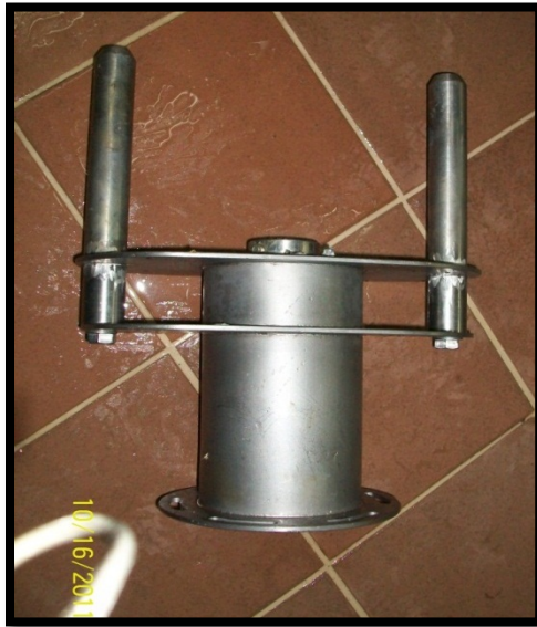
Figura 21 Camisa Flanche de Ajuste y Arrastre, Vista inferior (se observa la Manzana) 174
