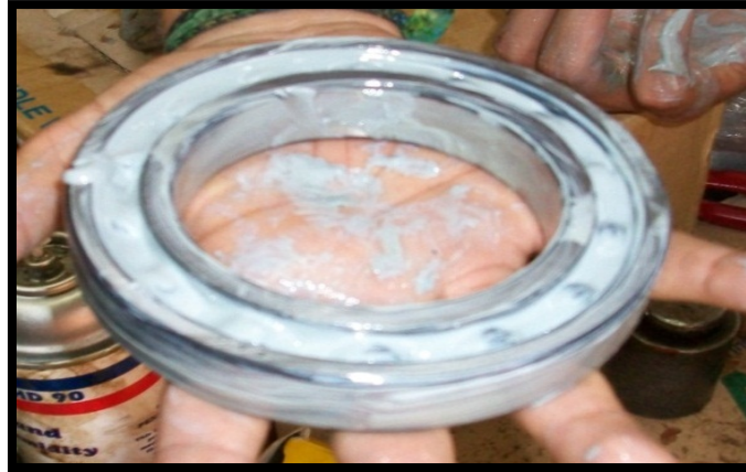
Figura 54 Segundo Rodamiento 6014 ya retirado del FLANCHE DE BRONCE 207
