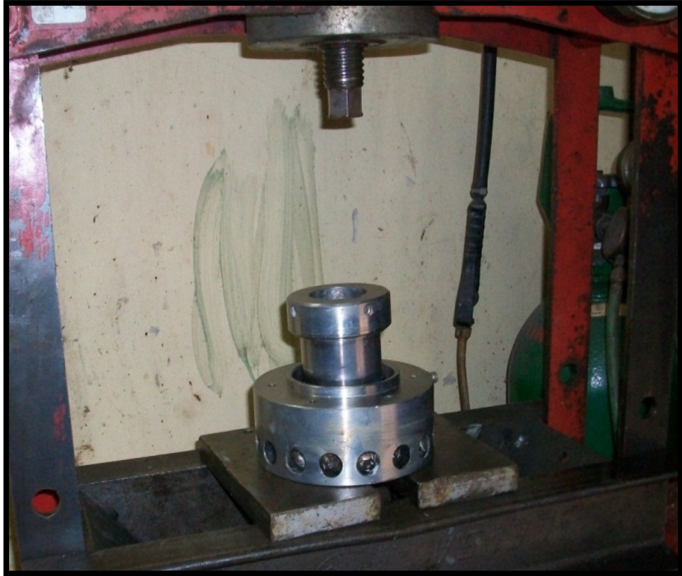
Figura 44 Procedimiento correcto para montaje del FLANCHE en la manzana 197
