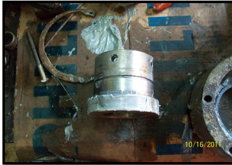
Figura 28 Fotografías Buje y CHAVETA 2 DEL FLANCHE D: 110mm 181
