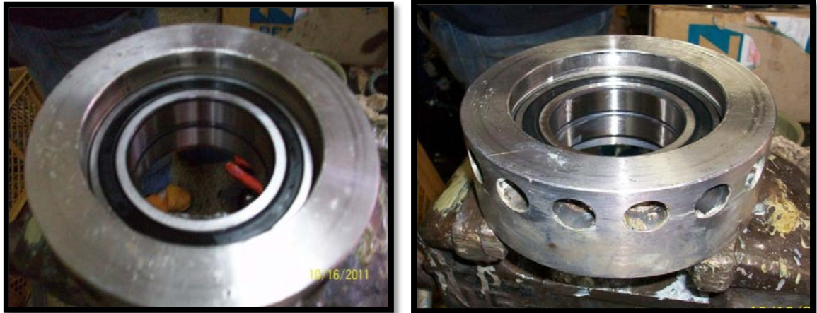
Figura 43 Nuevos RODAMIENTO 6014 ya montados en la Manzana 196
