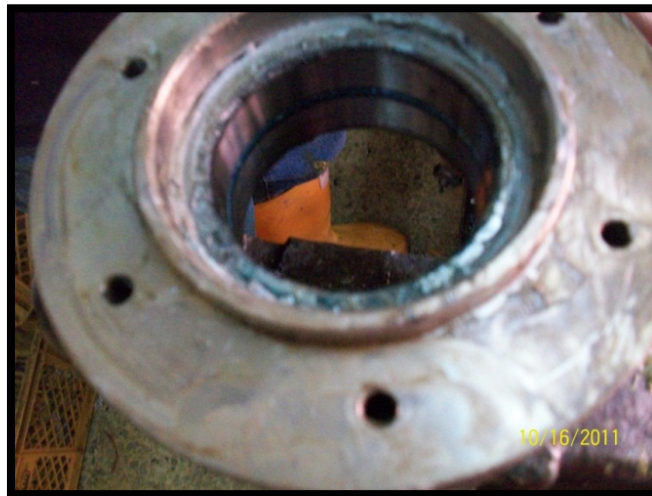
Figura 40 Manzana sin FLANCHE previamente retirado 193
