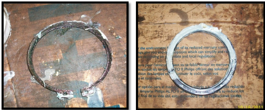
Figura 38 Retenedor y Chaveta inferior (RETENEDOR 80*110*10 y CHAVETA 2 DEL FLANCHE) 191
