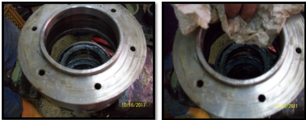
Figura 42 RODAMIENTO 6014 ya desmontados de la Manzana 195
