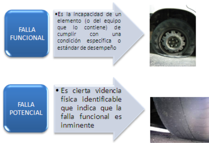
Figura 24 Falla Funcional vs Falla Potencial 29
