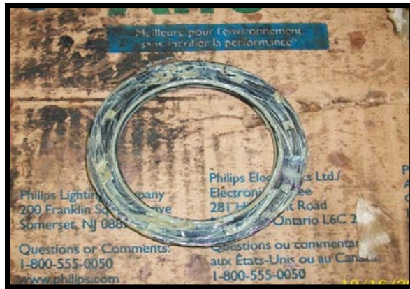
Figura 24 Fotografías RETENEDOR 70*90*10 desmontado. 177
