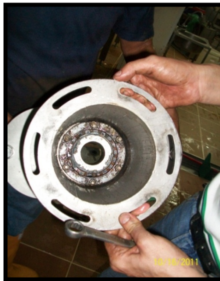
Figura 21 Camisa Flanche de Ajuste y Arrastre, Vista inferior (se observa la Manzana) 174
