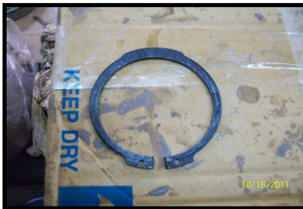
Figura 25 Fotografías CHAVETA 1 DEL EJE D: 70mm desmontado. 178
