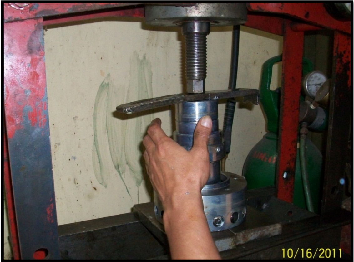
Figura 45 Procedimiento correcto para montaje del FLANCHE (utilizando barra) 198
