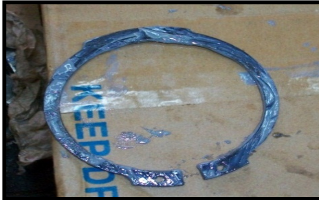
Figura 53 CHAVETA DEL EJE DE 70mm ya retirada del FLANCHE 206
