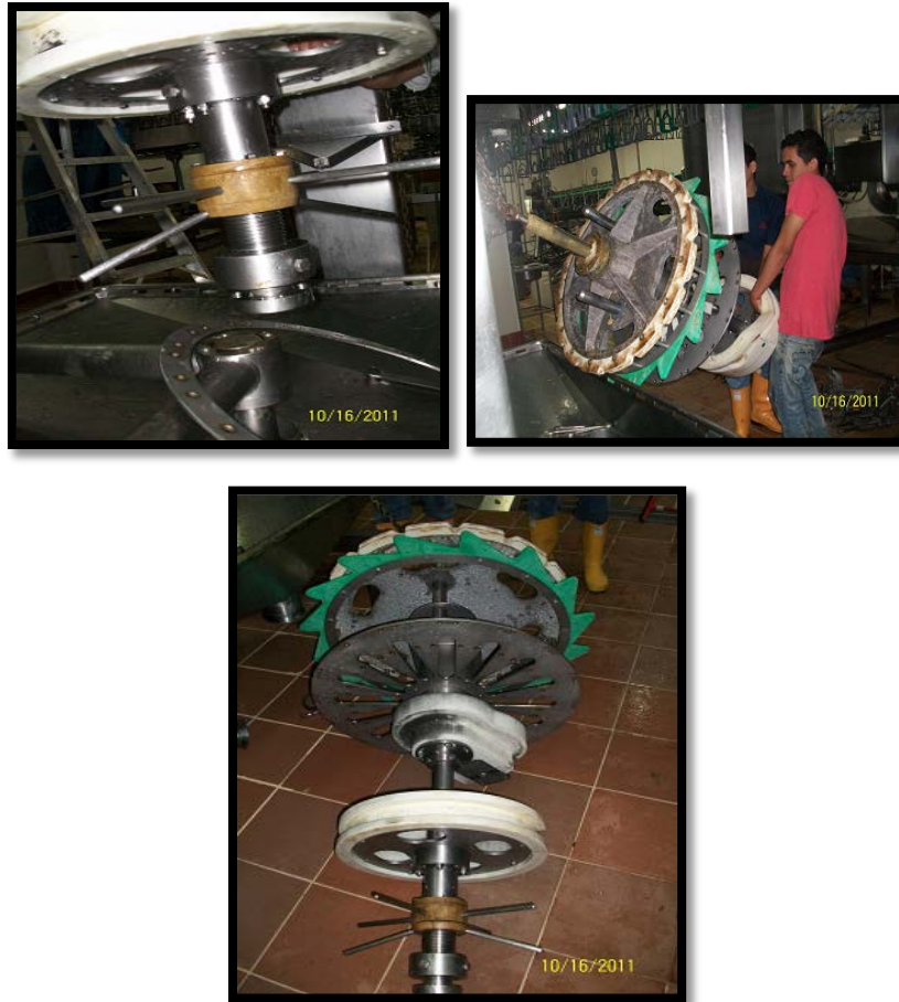
Figura 18 Proceso de desmontaje Equipo Corte de Abdomen 3. 171
