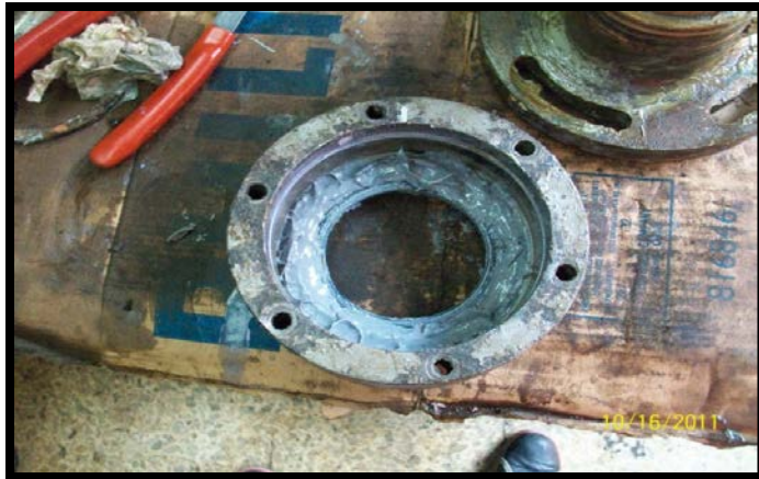
Figura 27 Fotografías Buje y Rodamiento 6014 180
