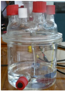
a. Celda electroquímica
