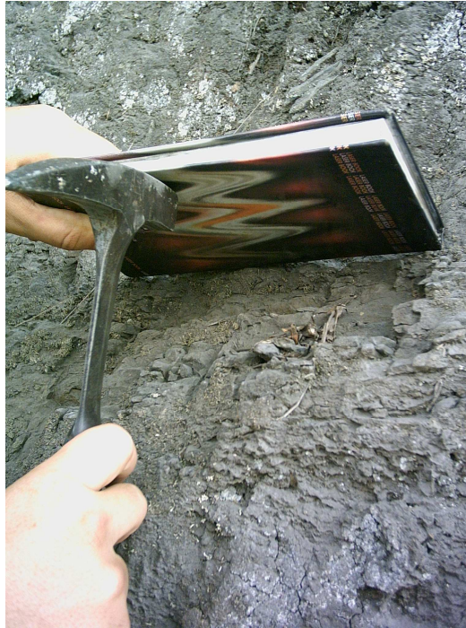
Figura 10. Intersección de planos de isotropía S1 y S2, indicados por la dirección de la libreta y el martillo. Afloramiento LME 061 001 (ver mapa ubicación de muestras, Figura 15)
