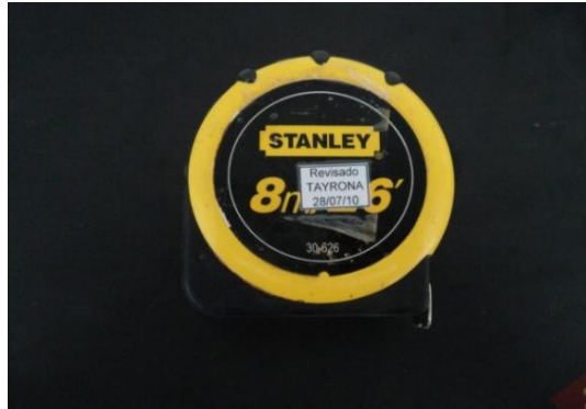
Ilustración 92. Colocación del sello de revisado
