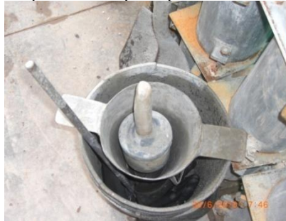
Figura 58. Implementos para prueba de asentamiento
