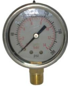
Figura 72. Manómetro para medición de presión del agua-Escala de medida 0 a 200 Psi.
