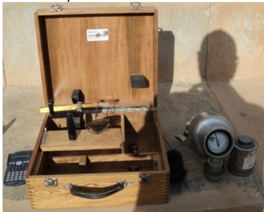
Figura 53. Instrumentos para hallar el contenido de humedad del suelo.
