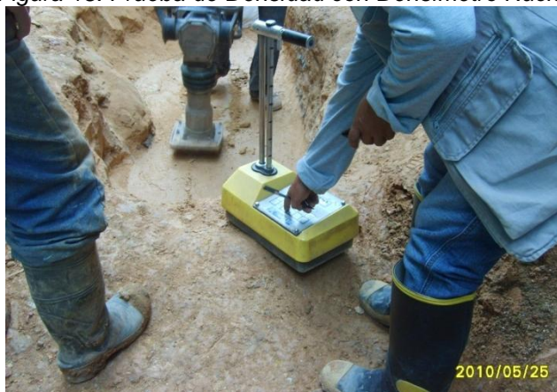
Figura 18. Prueba de Densidad con Densímetro Nuclear
