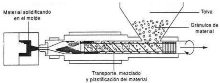
Figura 4. Plastificación del material
