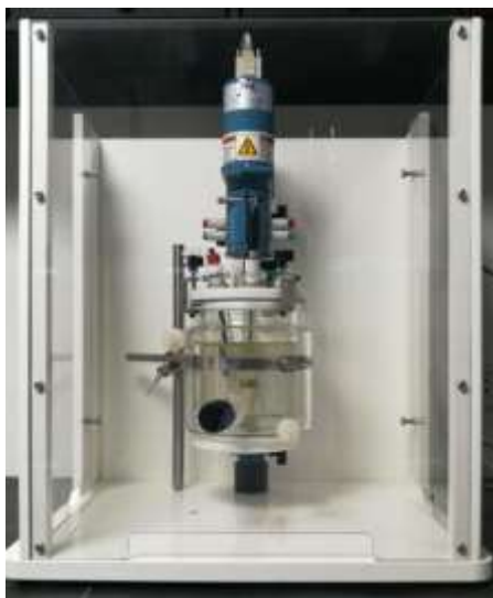
Figura 4. Equipo de electrodo de cilindro giratorio. Tomado de: http://tecnologitotal.net/analisis-electroquimico/
