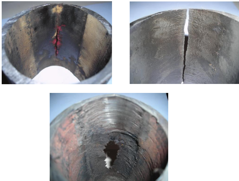
Figura 13. Partes de tubing desgastados por la varilla de la PCP. Sistema de transmisión lubricado [PDF]. (2013). Comodoro Rivadavia: Leoncio del Pozo, p10.
