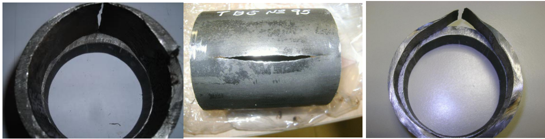
Figura 14. Partes de tubing desgastados por la varilla de la PCP. Sistema de transmisión lubricado [PDF]. (2013). Comodoro Rivadavia: Leoncio del Pozo, p12.
