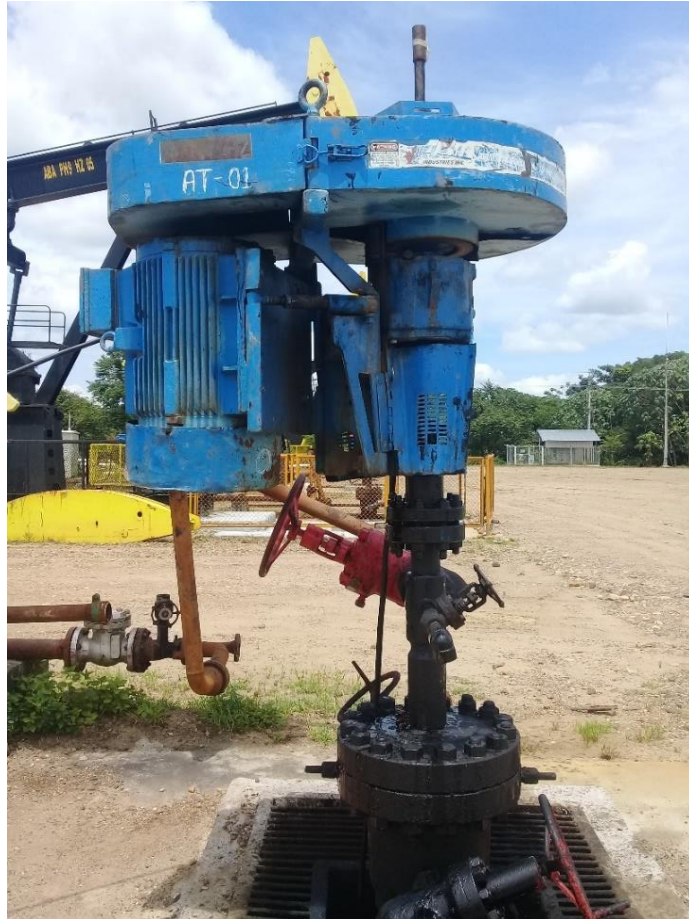
Figura 7. Cabezal de PCP Convencional.
