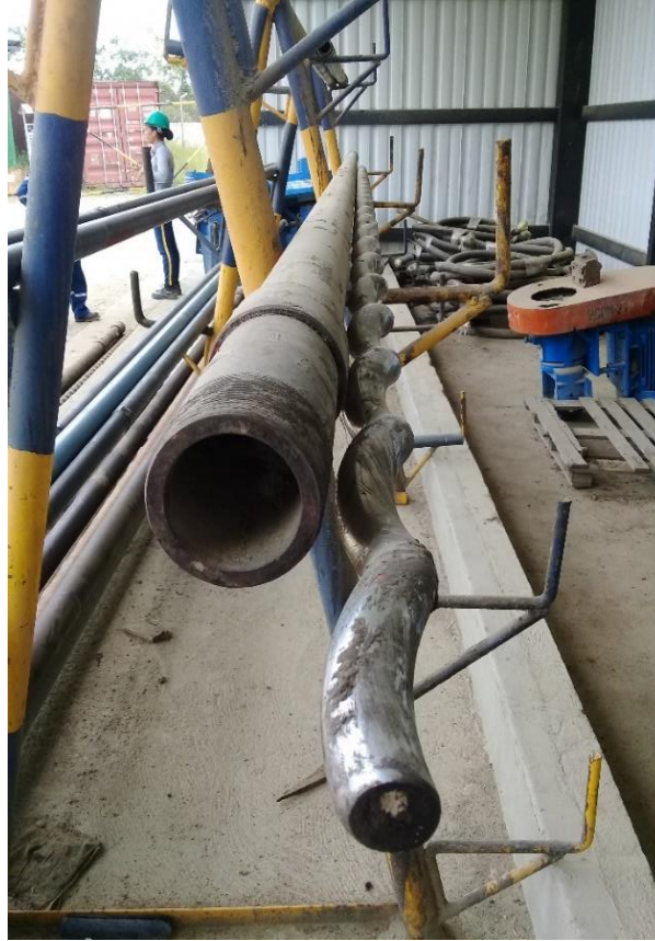
Figura 22. Estator y rotor de AMPCP (PCM).
