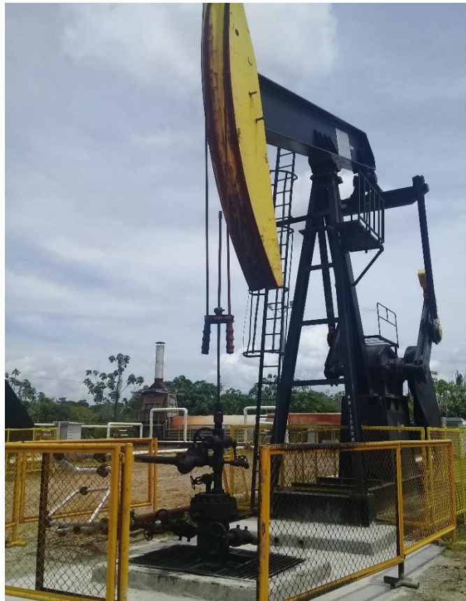
Figura 3. Unidad de Bombeo Mecánico con completamiento dual en fondo (Sistema Sarta Dual).
