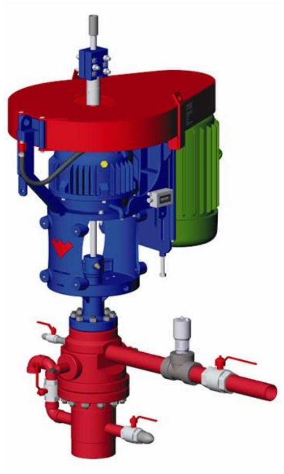
Figura 8. Cabezal de rotación (PCP).
