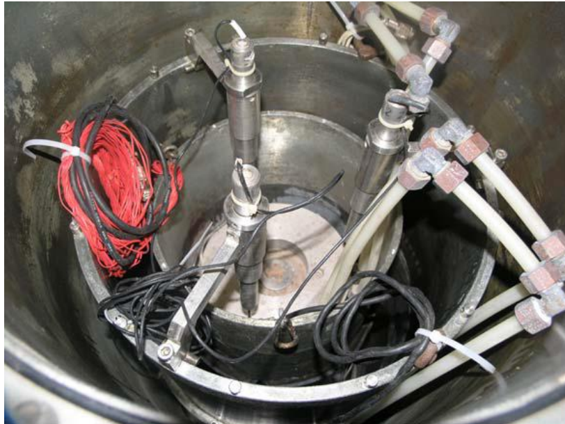
Figura 15 LVDTs colocados sobre el cabezal y la célula de carga del equipo Triaxial
