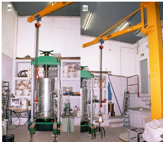
Figura 13 Equipo triaxial para materiales granulares gruesos con control de HR
