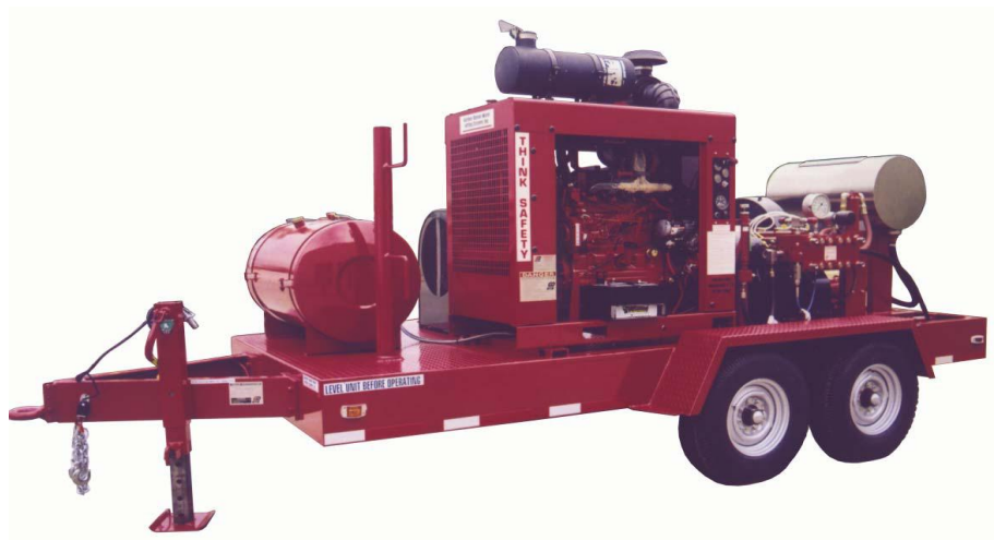
Figura 17. Máquina de alta presión Hidroject.
