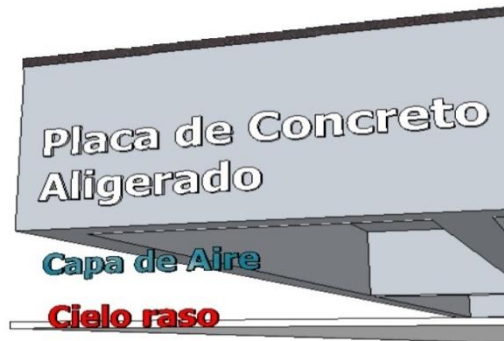
Figura A.8. Composición interna de los techos.
