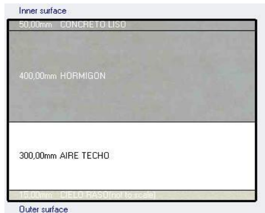
Figura A.9. Plantilla usada en DesignBuilder para simular la composición de los techos.
