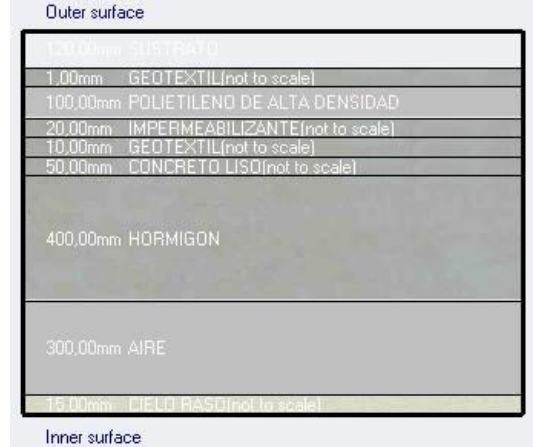
Figura A.7. Plantilla usada en DesignBuilder para definir el techo verde.
