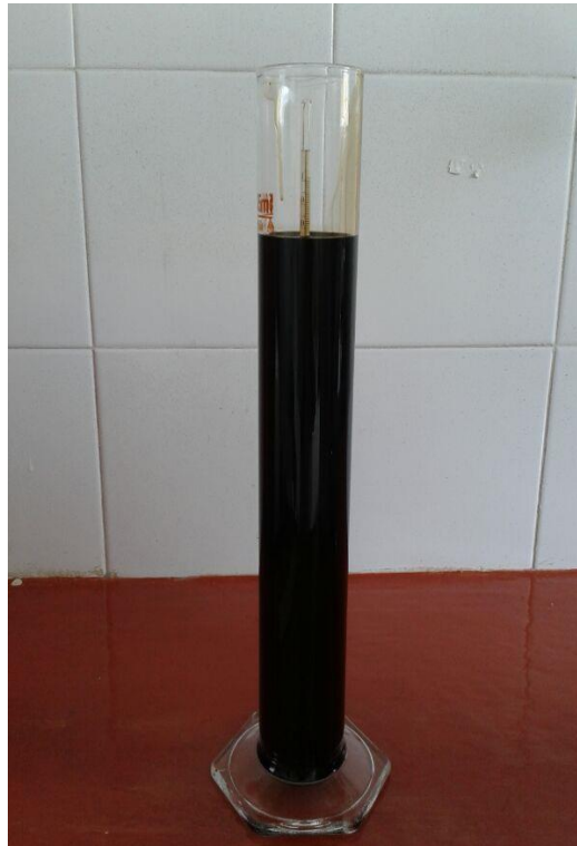
Figura 6. Determinación de Gravedad API Crudo Colorado Tanque
