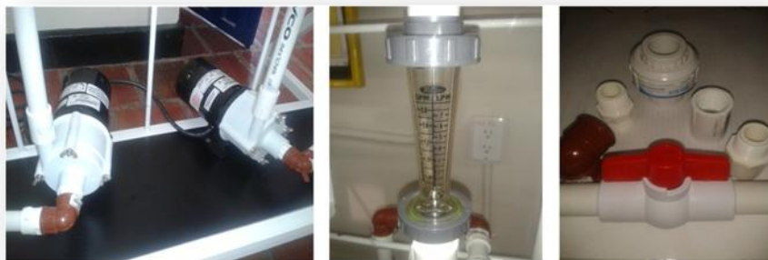
Accesorios utilizados en el montaje hidráulico del reactor de placas planas
