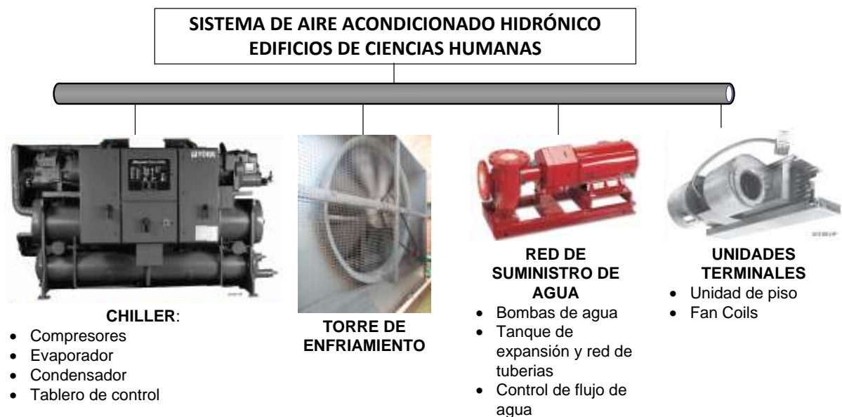
Figura 38. Componentes del sistema de A.A. Edificio Ciencias Humanas.
