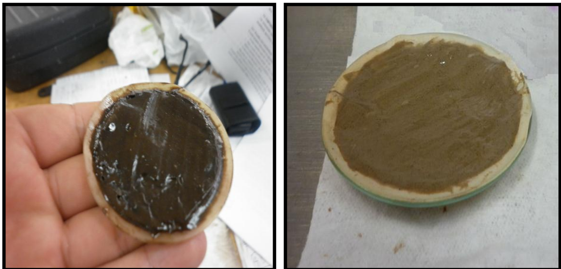
Figura A.16. Cake Formulación Filtrado relajado 80/20 Diesel y Biodiesel de Soya respectivamente
