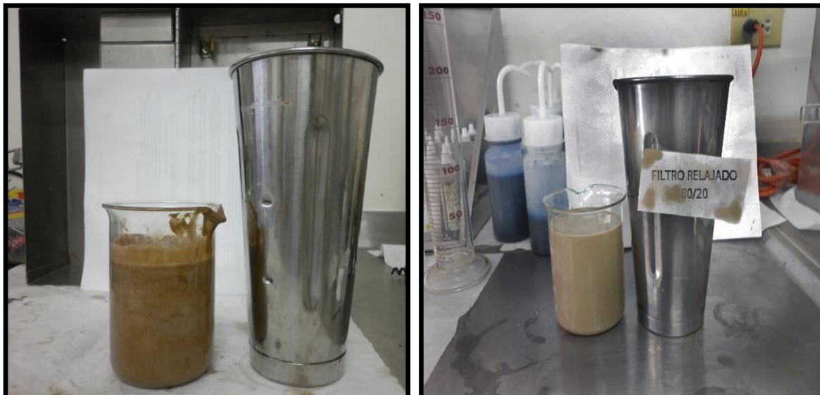
Figura A.13. Formulación Filtrado relajado 80/20 Diesel y Biodiesel de Soya respectivamente
