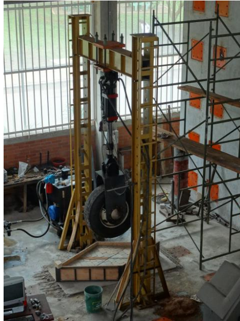
Figura 8. Marco de carga del laboratorio de estructuras de la UIS.
